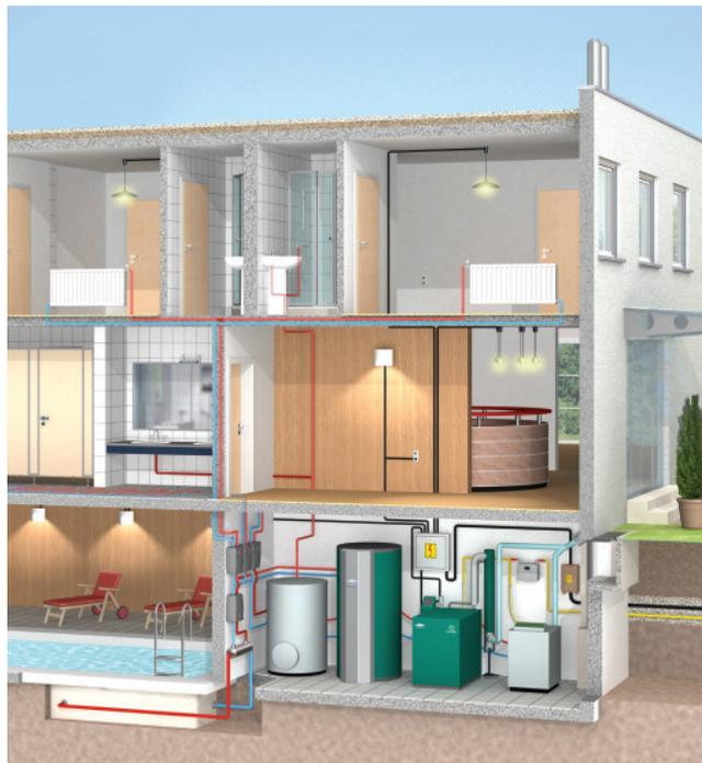
Elektrische und heizungstechnische Einbindung im Gewerbebetrieb mit dem Dachs SEplus
