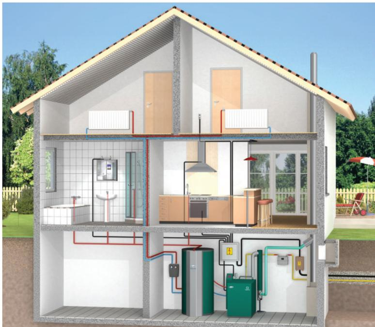
Elektrische und heizungstechnische Einbindung im Ein- und Mehrfamilienhaus mit dem Dachs SE
